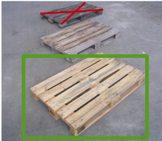
De bas en haut : palette blanche, palette noire 2e choix, palette noire 3e choix
